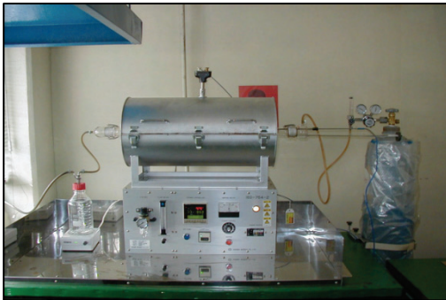
รูปที่ 2.6 ชุดอุปกรณ์ทดสอบทดสอบคุณสมบัติการปล่อยก๊าซกรด (acids gas emission)
