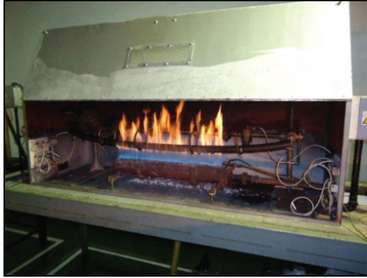
รูปที่ 2.9 การทดสอบ resistance to fire alone
